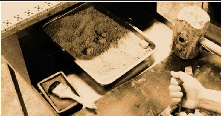
Клеммные колодки из фарфора, сделанные вручную путем прессования молотком: заполнение влажным гранулятом вручную (частную электротехнического фарфора после прессования (частная коллекция).
